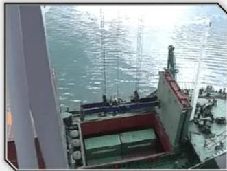
Il gruista addetto al carico di container su navi opera all'interno di una cabina posta sulla gru ad una altezza variabile tra i 35 e 40 metri di altezza.
