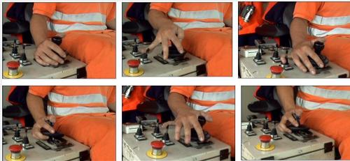
Per manovrare la cabina lungo il braccio della gru ed effettuare le operazioni di carico-scarico, l'operatore usa una STICK principale ed altre leve.
