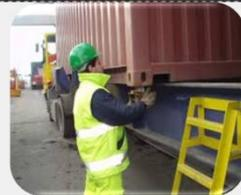
Gli STANTI sono protezioni laterali, fissate al vagone ferroviario, che hanno la funzione di fissare il container al treno: non vengono rimossi, ma innalzati e abbassati
